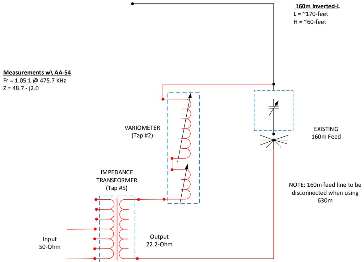
**Figure-6, 630m Transmit Antenna System**
